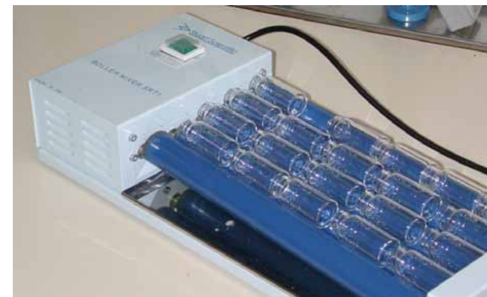
Bekämpningsmedel upplöst i aceton fördelas jämn över burkens inneryta
